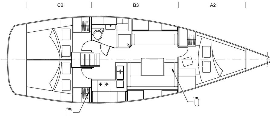
Alle Varianten: Ein Feuerlöscher im Cockpit-Staukasten (siehe Markierung an der Außenseite des Kastens)
