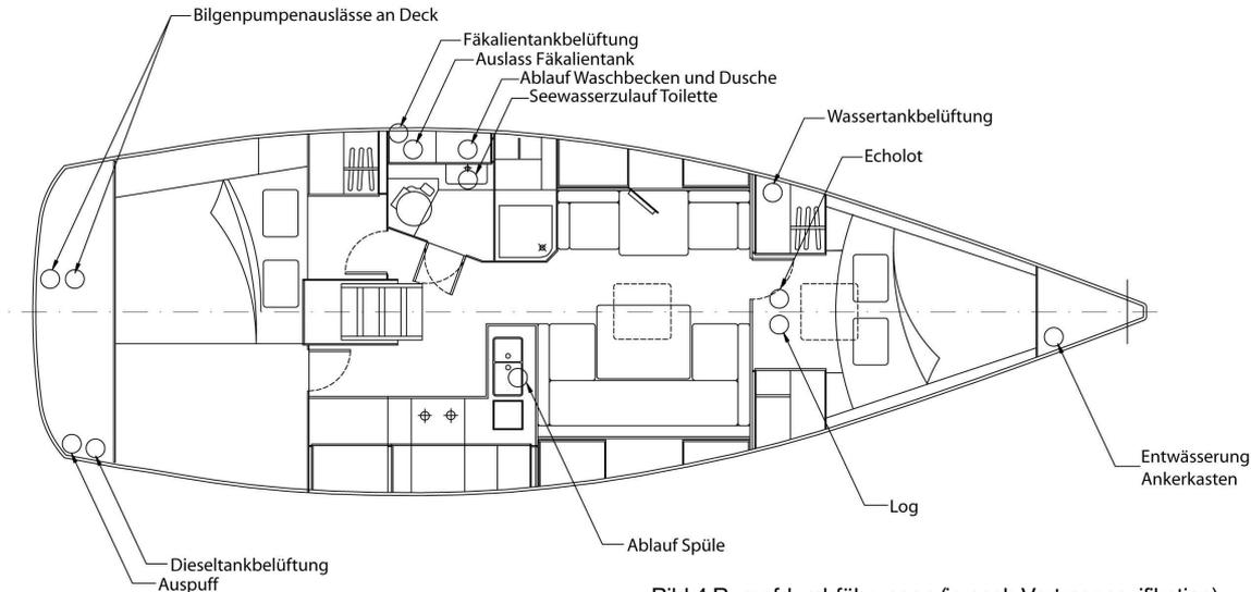
Aus Sicherheitsgründen sind die Schlauchverbindungen hier immer doppelt ausgeführt. Verändern Sie das nicht!
